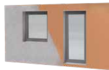
Ziegelfertigteile mit integrierter Lüftung, Fenster und Putz
