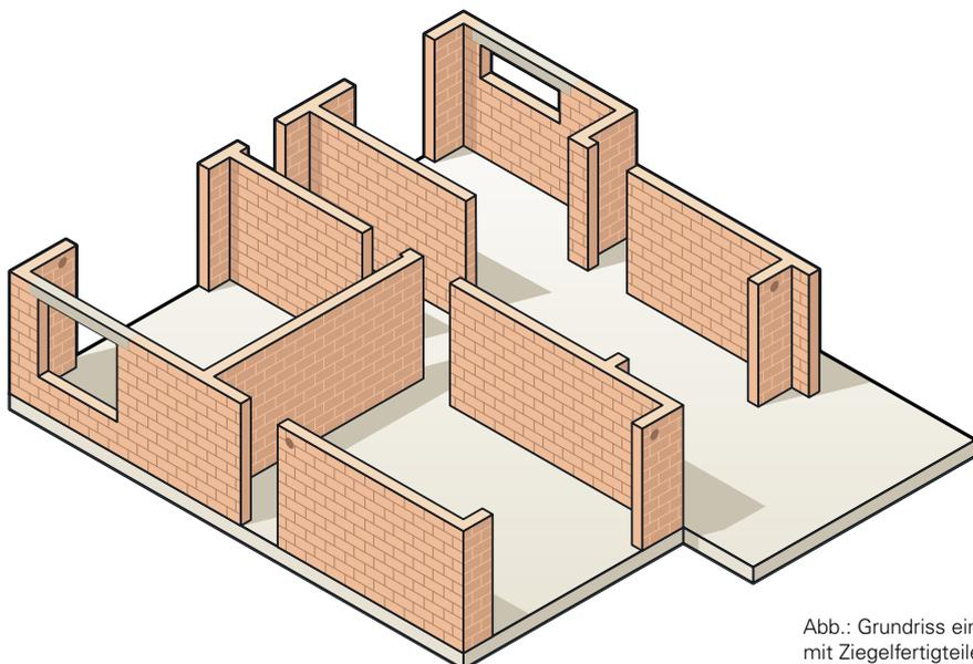
Abb.: Grundriss eines Rohbaus mit Ziegelfertigteilen
