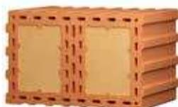
Geschosshoch mit Fließlehm verfüllt, eignet er sich für Schallschutz-/ Wohnungs-/ Haustrennwände. Geringes Gewicht und Planziegeltechnik ermöglichen schnelle und präzise Verarbeitung. Dabei reduziert der Umstieg von Beton auf Fließlehm den CO<sub>2</sub>-Ausstoß nachhaltig, ohne Beeinträchtigung der Statik und des Schallschutzes.
