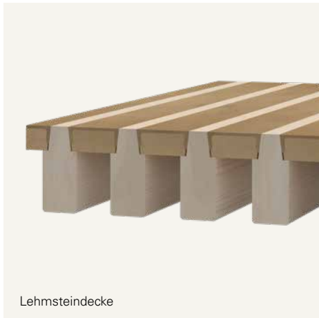
Deckeneinhängeziegel aus Lehm
